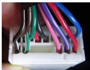
Abbildung 2: Detail: Stecker hinter Wechsler in der Mittelkonsole
